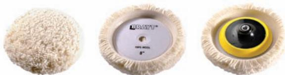
**WOLLPAD SEALINE BRAYT (WEISS)** – mit einer Polierseite, die aus 100% natürlicher Wolle besteht. Ideal um Kratzer und Vermattungen auf großen Oberflächen zu entfernen. Ein ideales Werkzeug, um Gelcoats, PU Deckanstriche und Siegelacke zu polieren. Der Durchmesser des Pads - 200 mm, mit Klettverschluss ø-150 mm
