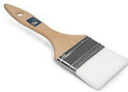
Besonders empfohlen für Decksacke - Farben, Lacke, Klarlacke und Gelcoats. Computergeformte Fasern mit einer Länge von 51 mm, mit entsprechender Härte in Kombination mit Topcoats von höchster Qualität garantieren einen guten Verlauf der Farbe. Die ideale Bürstendicke (8 mm) zum einfachen Auftragen der richtigen Farbmene für eine Beschichtungsschicht.
