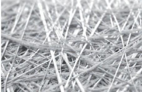
Glasfasermatten werden in Verbindung mit Laminierharz für die Reparatur von großen Löchern in Booten, Yachten, Caravan usw. verwendet. Die zu reparierenden Flächen können aus Stahl, Aluminium oder GFK bestehen, die dann mit Glasfaser verstärkt werden. Die neuen Schichten haben ein hohes Haftungsvermögen, sind langlebig gegen Benzin, Öle, Fette und kurzzeitig bis zu 70°C widerstandsfähig.
