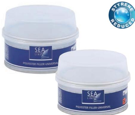
Moderner Spachtel zum Füllen und für Finisharbeiten. Es hat eine ausgezeichnete Haftung auf folgenden Oberflächen: Polyesterlaminat, Zweikomponenten Acrylgrundierungen, Stahloberflächen, Holz, verzinkte Stahloberflächen und Altackbeschichtungen. Sehr einfach in der Anwendung, mit einem charakteristischen Selbstglättungseffekt. Komfortabel zum Schleifen im ausgehärteten Zustand.
