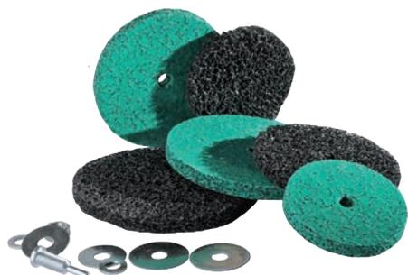
Eine Schleifscheibe aus einem harten Vlies, das mit dem Schleifmittel imprägniert wurde. Das Produkt dient zur Entfernung von Lackschichten, Grundierungen, Rost, Dichtungs- und Schutzschichten. Es ist sowohl für die Reinigung von flachen Oberflächen als auch von geformten Metallelementen geeignet. Erhältlich auch in der Version „LUX“, elastischer, robuster und ergiebiger ist. Reinigungsvliese können in einem Satz mit dem Befestigungsgriff gekauft werden.
