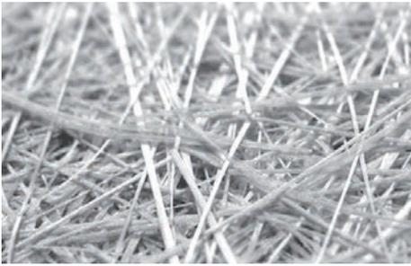
Das Glasfasermatte bei Verwendung mit Laminierharz wird für die Reparatur von großen Löchern in Karosserien, Booten, Yachten, Wohnwagen usw. empfohlen. Die reparierten Elemente können aus Stahl, Aluminium oder GRP bestehen und mit Glasfasern verstärkt werden. Die entstandene Schicht zeigt eine gute Haftung, ist benzin-, öl-, schmierbeständig und auch beständig gegen kurzzeitige Temperatureinflüsse bis 70°C. Nicht auf reaktive Untergründe, 1K-Akryl- und Nitrozellulose-Produkten anwenden.
