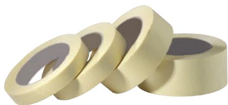
Hochqualitatives Lackierband für die Automobilindustrie, das sehr gute Haftung auf unregelmäßigen Oberflächen aufweist. Sehr leicht entfernbar (es hinterlässt keine Kleberückstände). Kompatibel mit den meisten Lacken und Farben. Hitzebeständig bis zu 80 Grad. Träger: gelbes, flach gekrepptes Papier. Kleber: Naturkautschuk.
