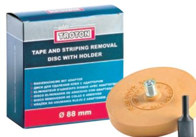
Gummischeibe zum mechanischen Entfernen von Klebstoffresten, Klebebändern, Aufklebern, u. ä. Sicher für den Lack, verursacht keine Kratzer. Das Produkt ist sehr robust und mehrfach verwendbar. Der Adapter ermöglicht das Einspannen der Radierscheibe in die Bohrmaschine. Antriebsgewinde: 5/16" x 24
