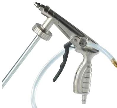
Eine Spritzpistole mit Druckregulierung für Karoserieschutzmittel und Fahrgestellkonservierungsmittel. Eigenschaften: leichte solide Konstruktion, selbstzentrierende Düse, Plastikschlauch für die Dosierung in geschlossenen Profilen. Die Einstellung der Strahlbreite und des Farbdurchflusses ist möglich.
